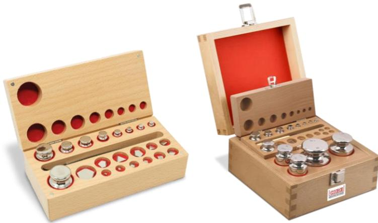
A hitelesíthető rozsdamentes acél súlysorozat alkalmasak mérésügyi, kutatási és ipari alkalmazásra. Az E2 pontossági osztály lehetővé teszi a súlyok használatát a hármas (CLASS II) pontossági osztályú mérlegek (legfeljebb 500 000 e) ellenőrzésére és kalibrálására.
